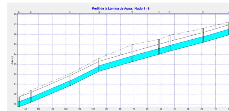
Imagen,. Perfil longitudinal calculado colector OTDL Bar Anita (Fuente: Elaboración propia)
